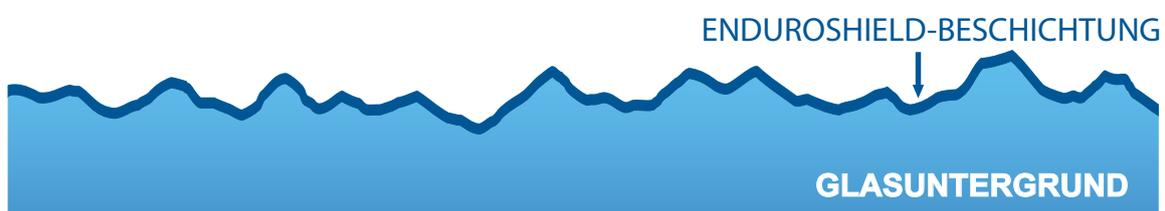
Abb. 2: EnduroShield passt sich Glaserhöhungen und -vertiefungen an
