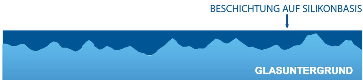
Abb. 1: Wettbewerbsprodukte, die die Glasvertiefungen lediglich ausfüllen
